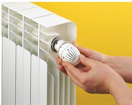
Acoplar el cabezal termostático a la válvula con una ligera presión, haciendo coincidir las pestañas sobre los resaltes de la válvula.
