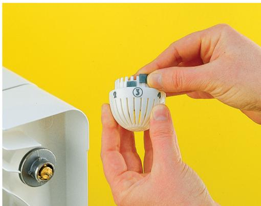
Para bloquear el volante en la posición deseada es necesario insertar en las guías ambos limitadores, posicionándolos a la derecha e izquierda del número elegido.
