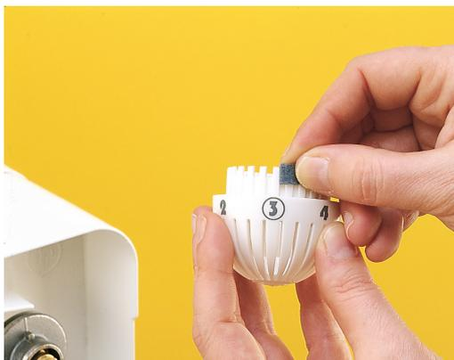
La parcialización de apertura se obtiene insertando el limitador en las guías correspondientes situadas sobre el volante a la derecha del número deseado.
