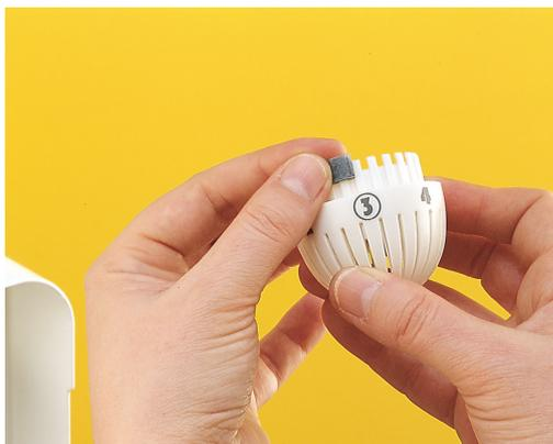
La parcialización del cierre se obtiene insertando el limitador en las guías correspondientes situadas sobre el volante a la izquierda del número deseado.
