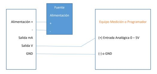
Debido a que en las mediciones en corriente no existe caída de tensión debido a la longitud del cable usado, aconsejamos pues, el conexionado 4 - 20mA siempre que sea posible sobretodo en largas distancias.
